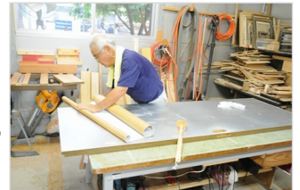
戸板のシート貼り付け
